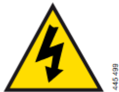
Varningsskylt för klass B-spänning.
